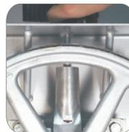
Mantiene la tensión correcta de la cinta banda, alargando la vida de la misma y realizando cortes rápidos y precisos. Cuenta con un punto indicador para facilitar el ajuste.
