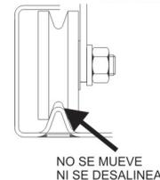
El carro cuenta con un sistema de rodamientos sólidos en acero inoxidable, montados dentro de una guía-canal de acero inoxidable, diseñado para trabajo pesado, manteniendo siempre su alineación y sujeción.
