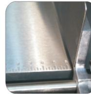
Regulador de espesor de corte graduado que permite ajustar fácilmente el grosor de los cortes, ayudando a tener productos más consistentes.
